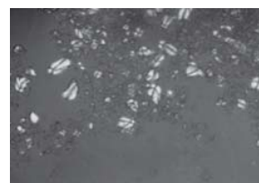
图12 全藕粉 1-300 的偏光显微镜图(× 200 倍)
