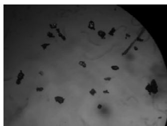
图2 显微镜下富马酸二甲酯微胶囊图( \times 100 )
