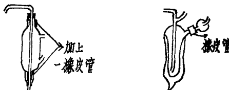
图2 改进后的1761型微量定氮蒸馏器
