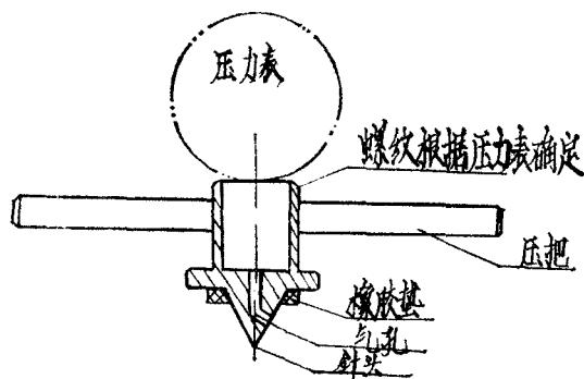
检测前将瓶子上下轻轻摇动，使钻针尖端对正瓶盖，用双手向下压去穿孔，注意观察压力表指针移动，当瓶内压力达到 $2.1\sim2.8\text{ kg/cm}^2$ （含二氧化碳量 $0.3\sim0.4\%$ ）即可下架进行消毒处理（因后酵室温一般为 $20\sim25^\circ\text{C}$ ，故温差影响压力可略而不计）。对于中小型格瓦斯厂使用水泥槽或铁板槽简易槽式消毒较为理想，经济。
