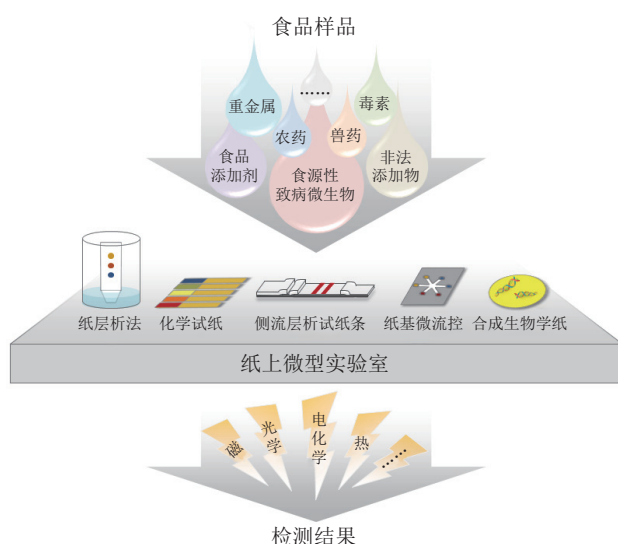
图1 “纸上微型实验室”的原理 Fig.1 Principle of “lab on paper”
